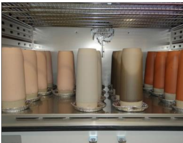
(a) Trocknen der geschichteten Kerne im Ofen Abbildung 8. Behandlung der geschichteten Kerne
